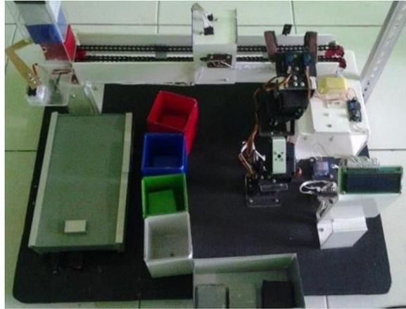
Gambar 3. Hasil rancangan sistem secara keseluruhan serta tampilan LCD
